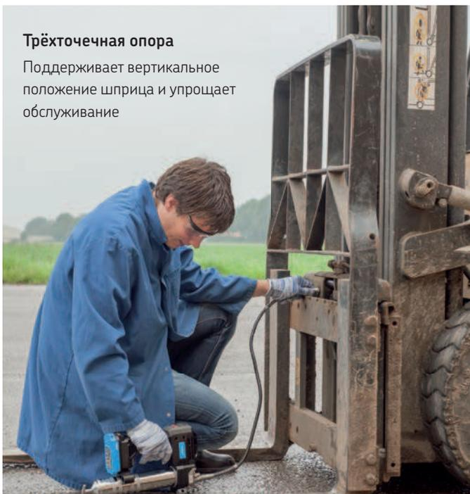
На дисплее прибора отображается уровень заряда батареи, расход пластичной смазки, обороты насоса/электродвигателя и заблокированные точки смазывания. Этот универсальный шприц обеспечивает работу в двух режимах — низкого и высокого расхода, а заряда батареи хватает для опорожнения 15 картриджей пластичной смазки. Шприц TLGB 20 может работать с давлением до 700 бар (10 000 фунтов/дюйм), а встроенный светодиод позволяет освещать рабочую область.
