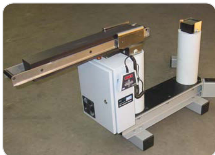
Рисунок 3: TH L с открытым затвором сердечника
